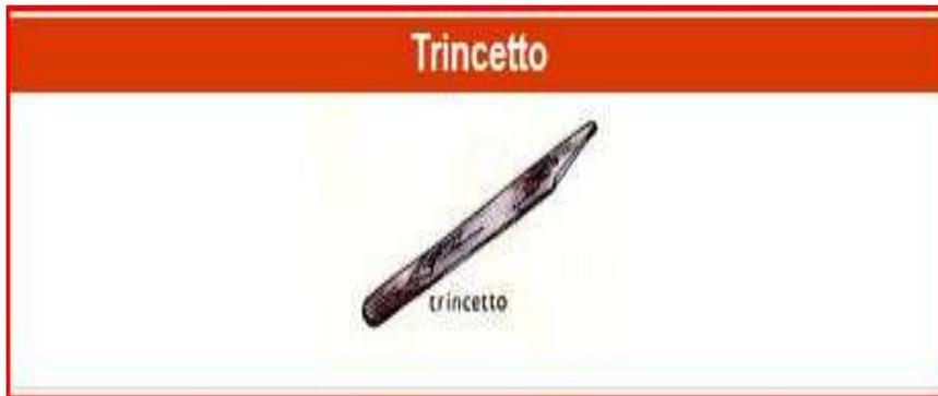
Strumento usato dal calzolaio per tagliare il cuoio, costituito da una lama d'acciaio leggermente curva con il tagliente obliquo
