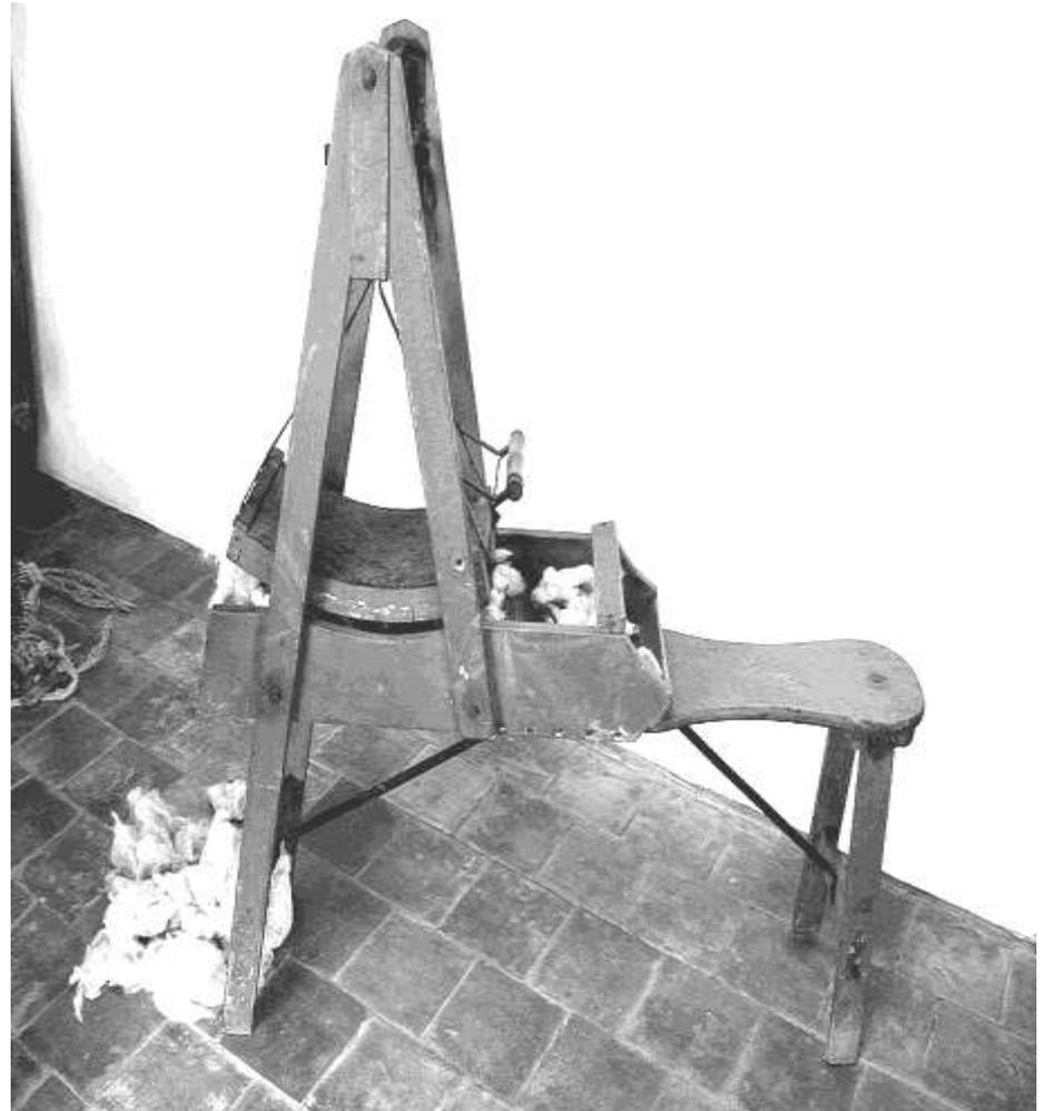
La trapuntatura consisteva, una volta rifatto il materasso, di infilare uno spago attraverso il materasso a distanze regolari di circa 20 cm, lo spago veniva fissato da entrambe le parti con un pezzo di stoffa. L'operazione impediva che la lana si spostasse da una parte o dall'altra del materasso durante l'uso. Quasi sempre il materassaio era anche tappezziere.
