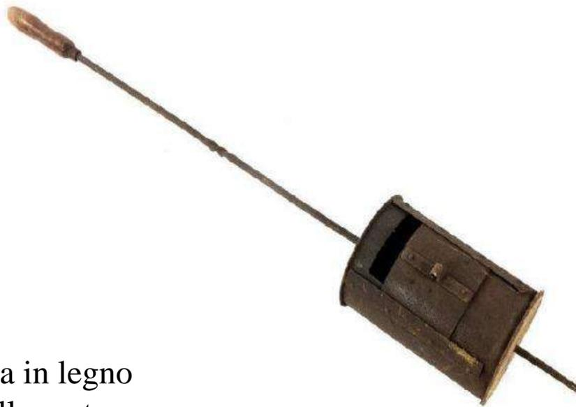
**Macinacaffè** costituito da una scatola in legno quadrata, da un cassetto estraibile nella parte inferiore e da un coperchio sormontato da una piccola cupola dove sporge un'asta in ferro terminante con un pomello in legno. Poteva avere anche forma cilindrica.
